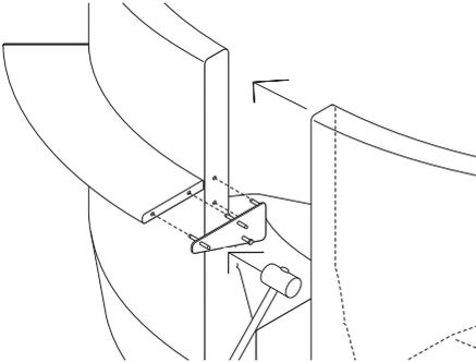
Setzen Sie die Halterung Mitte an den Befestigungslöchern des Elementes und des Ablagebrettes an und klopfen diese mit einem Gummihammer hinein, bis es bündig mit dem Element ist
