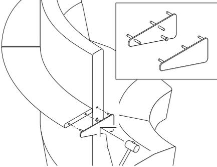
Montieren Sie eine weitere Halterung Mitte (siehe ab Punkt 4) oder eine Halterung links.
