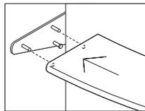
Stecken Sie das Ablagebrett auf die Bolzen der Halterung.
