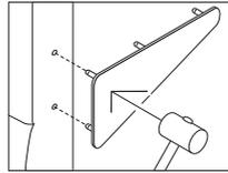
Setzen Sie die Halterung rechts an den Befestigungslöchern des Elementes an und klopfen diese mit einem Gummihammer hinein, bis es bündig mit dem Element ist.
