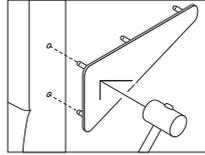
Setzen Sie die Halterung rechts an den Befestigungslöchern des Elementes an und klopfen diese mit einem Gummihammer hinein, bis es bündig mit dem Element ist.
