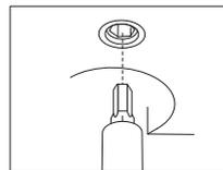
Ziehen Sie die Madenschrauben (diese finden sie auf der Unterseite des Ablagebretts) mit einem Inbusschlüssel (Größe 4 mm) fest.
