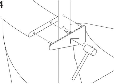
Setzen Sie die Halterung links an den Befestigungslöchern des Elementes und des Ablagebrettes an und klopfen diese mit einem Gummihammer hinein, bis es mit dem Element bündig ist.
