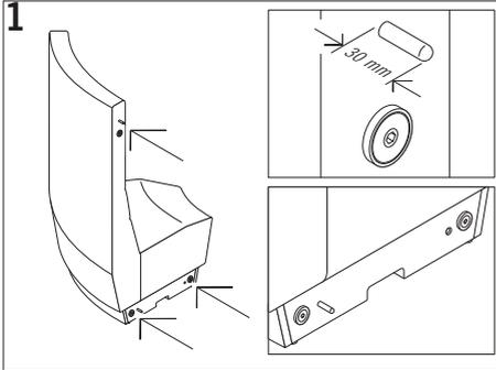
Affair-Elemente werden immer werkzeuglos miteinander verbunden. Zwei Elemente werden untereinander mittels eines Bolzens positioniert und durch Magnete zusammengehalten.
