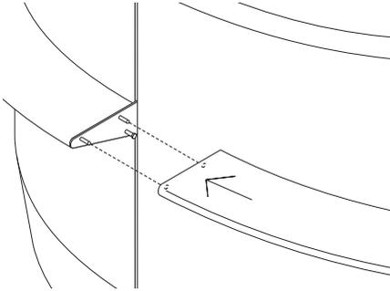
Stecken Sie das zweite Ablagebrett auf die Bolzen der Halterung Mitte.
