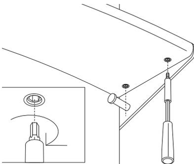
Ziehen Sie die Madenschrauben (diese finden sie auf der Unterseite des Ablagebrettes) mit einem Inbusschlüssel (Größe 4 mm) fest.
