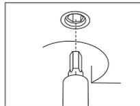
Ziehen Sie die Madenschrauben (diese finden sie auf der Unterseite des Ablagebretts) mit einem Inbusschlüssel (Größe 4 mm) fest.
