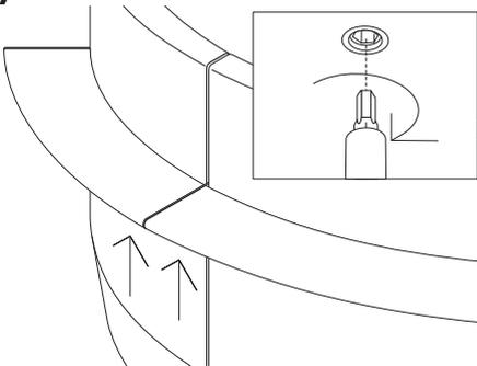
Ziehen die Madenschrauben (diese finden Sie auf der Unterseite des Ablagebrettes) mit dem Inbusschlüssel (Größe 4 mm) fest.
