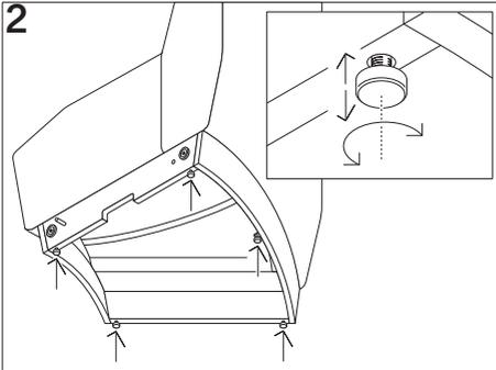
Alle Affair-Elemente sind mit Nivelliergleitern ausgestattet. Diese Gleiter können ca. 20 mm herausgedreht werden.
